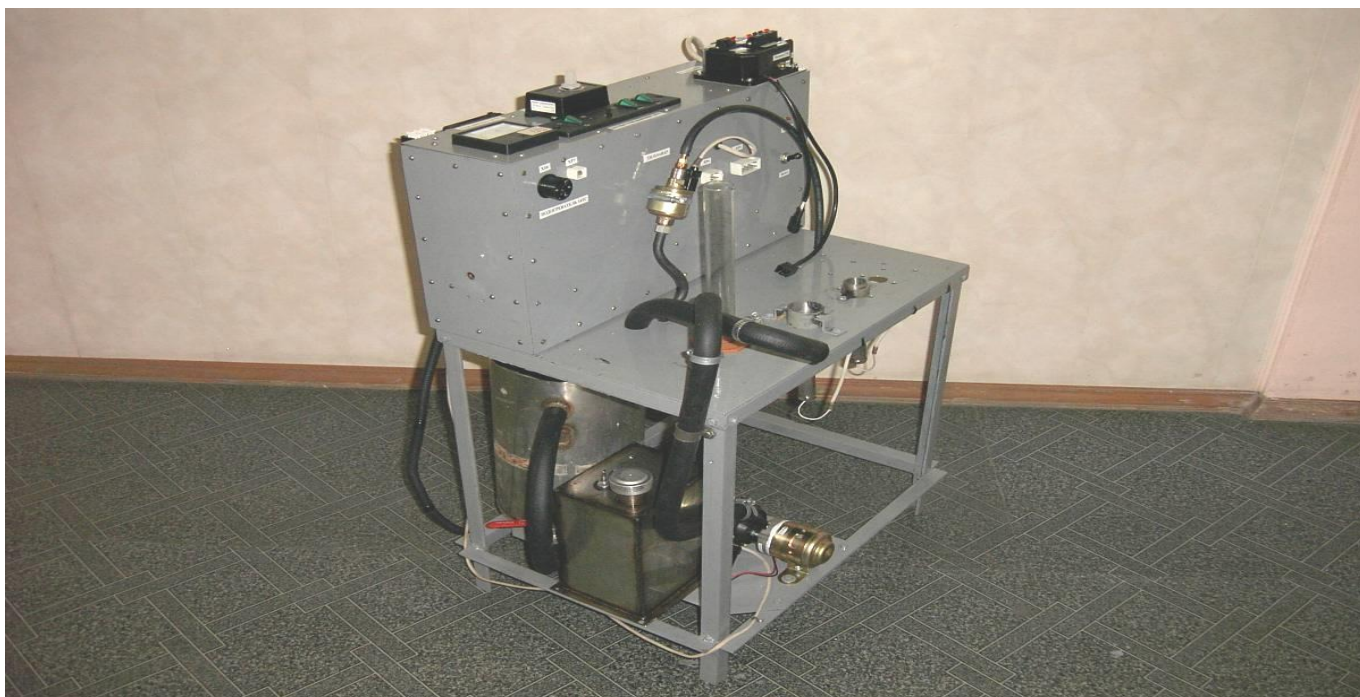
Рис. 13 – Стенд контроля подогревателя
